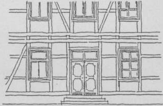
Abb. 9: Fensteröffnungen, geschossweise Bezugnahme aufeinander (§ 7 Abs. 2)
