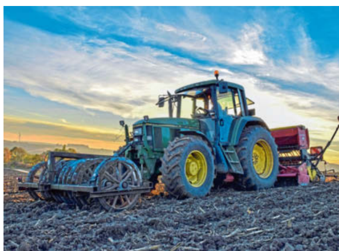
Bauern sind mit dem Aussäen von Raps beschäftigt. Vorn der Frontpacker für das Zerkrümeln der Erdkrumen, hinten die Sämaschine, die die Rapssamen passend unter der Erde ablegt. FOTO: F. POTTKAMP
