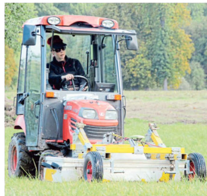
Auf acht Zentimeter genau: Radar-Archäologin Tanja Trausmuth scannt den Boden ab.
