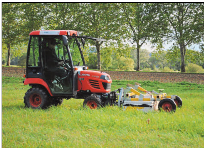
Tanja Trausmuth (Ludwig-Boltzmann-Institut) auf einem der Felder in Corvey: Der Traktor schiebt Radarsonden vor sich her.
