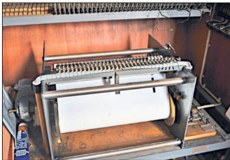
Blick ins Innere: So sieht die Automatik aus – verschiedene Musikstücke sind auf Walzen festgehalten, die täglich abgespielt werden.
