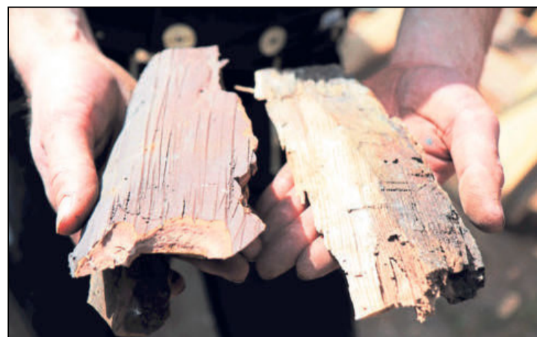
Der Unterschied: links ein Stück Epoxidharz aus den 1980er Jahren, rechts »echtes« Holz.
